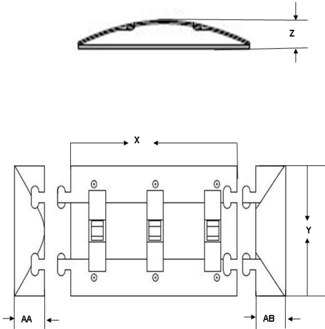
Figura ilustrativa 5. Dimensiones reductor de velocidad
