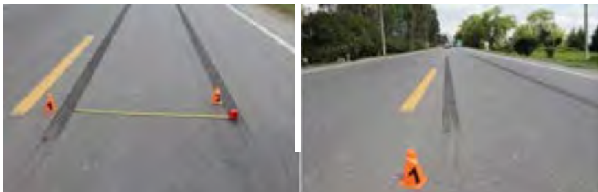
Imagen 60 y 61. Fotografías plano medio y primer plano de una huella de frenado. Fuente: archivo caso investigado.
