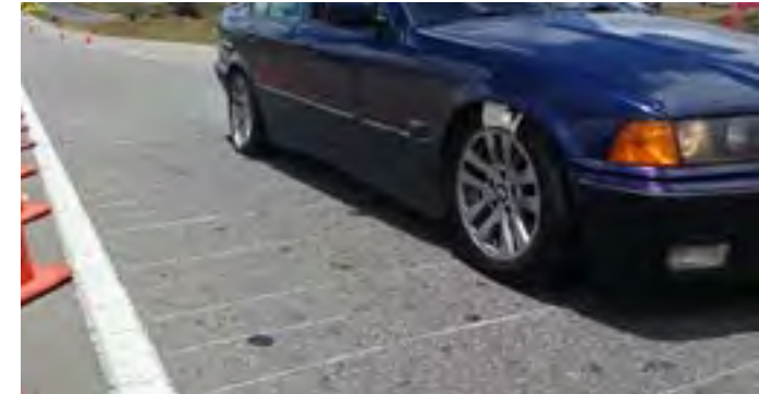
Imagen 112. Vehículo liviano, frenado de emergencia sobre asfalto, pruebas realizadas en el 2014. Fuente: Archivo institucional 2014.
