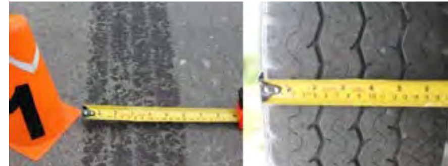
Imagen 51 y 52. Fijación fotográfica de huella de frenado para cotejar con la llanta. Fuente: archivo académico caso investigado
