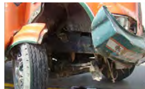
Imagen 80. Ejemplo de un desplazamiento posterior del eje. Fuente: Archivo personal.
