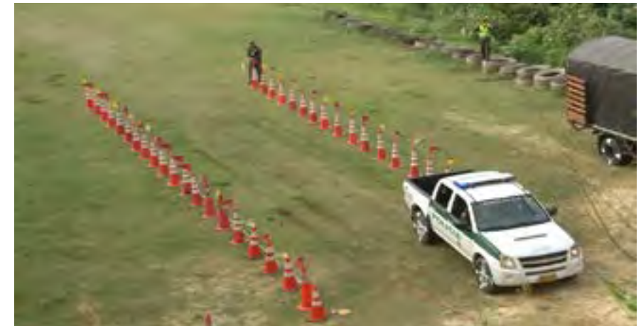
Imagen 105. Prueba de frenado sobre césped en Ibagué Tolima. Fuente: Archivo institucional 2015 de la ESEVI.
