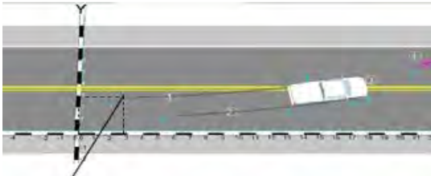
Imagen 88. Ejemplo de identificación del punto 1: se encuentra en 2.29 m en el eje X, y 3 m en el eje Y donde la descripción es: inicio huella frenado. Fuente: Archivo ESEVI software EDGE FX.
