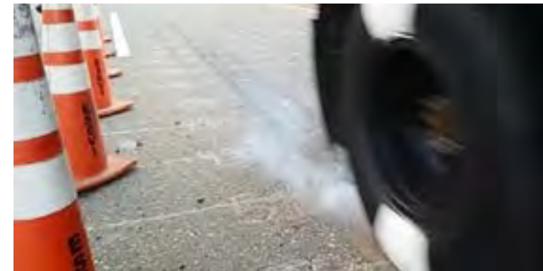
Imagen 114. Vehículo camión, frenado de emergencia sobre asfalto, pruebas realizadas en 2014. Fuente: Archivo Investigación Institucional ESEVI 2014.
