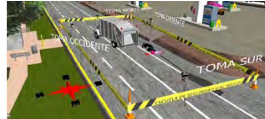
Imagen 55. Imagen que ilustra las 4 posiciones desde donde deben tomarse las fotografías panorámicas siempre que sea posible. Fuente: Archivo ESEVI docente Andrés Pinzón software EDGE FX.
