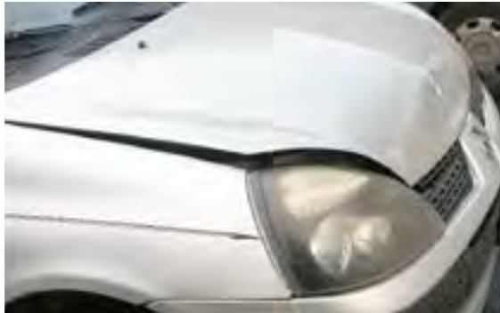
Imagen 81. Ejemplo de una hendidura sobre la carrocería. Fuente: Archivo personal.
