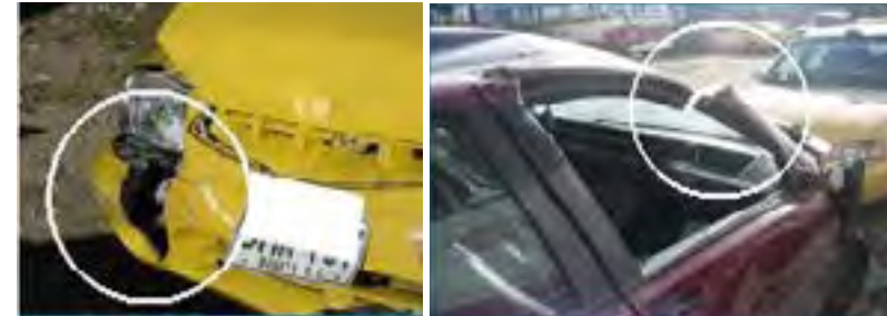
Imagen 83. Ejemplo de una rotura parcial y otra total de partes de la carrocería. Fuente: Archivo personal.
