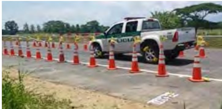
Imagen 113. Vehículo camioneta, frenado de emergencia sobre asfalto, pruebas realizadas en 2014. Fuente: archivo investigación institucional ESEVI 2014.
