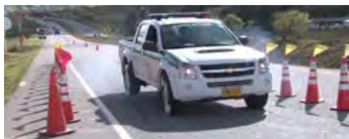
Imagen 109. Prueba de frenado de emergencia sobre asfalto en Tunja Boyacá. Fuente de archivo institucional 2014 de la ESEVI.
