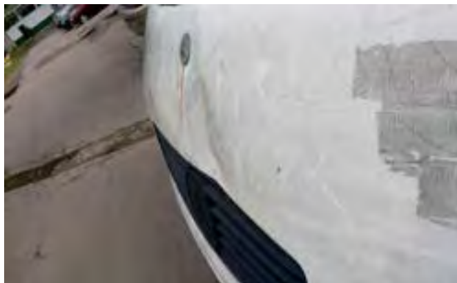
Imagen 78. Ejemplo de hundimiento de la carrocería. Fuente: Archivo personal.
