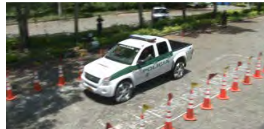
Imagen 116. Vehículo camioneta, pruebas de frenado de emergencia sobre adoquín en Ibagué Tolima. Fuente: Archivo Investigación Institucional ESEVI 2015.
