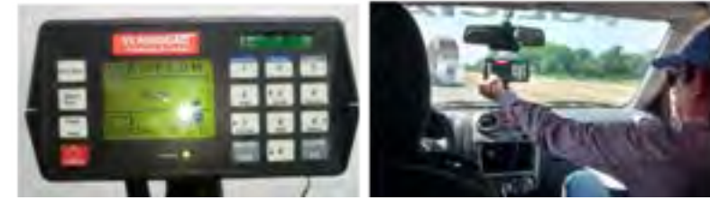
Imagen 110 y 111. Acelerómetro VERICOM 4000 DAQ con el que se realiza la toma de información en las pruebas realizadas en el 2014 y 2015. Fuente: archivo institucional 2015.
