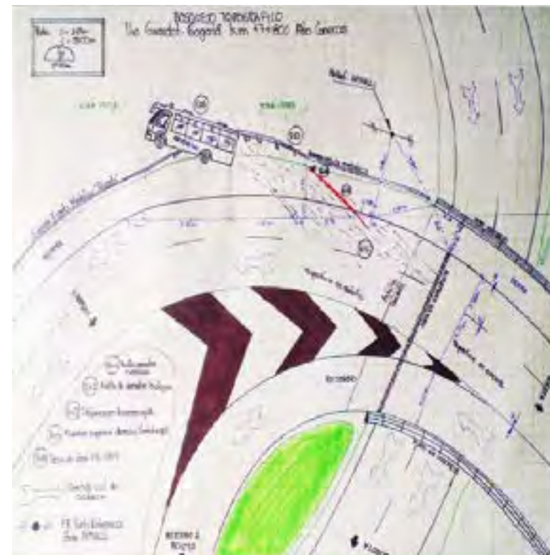
Imagen 92. Ejemplo de un bosquejo topográfico fijado y acotado método ortogonal. Fuente: Archivo Subintendente Fabián Castillo Bejarano. Laboratorio móvil de criminalística.
