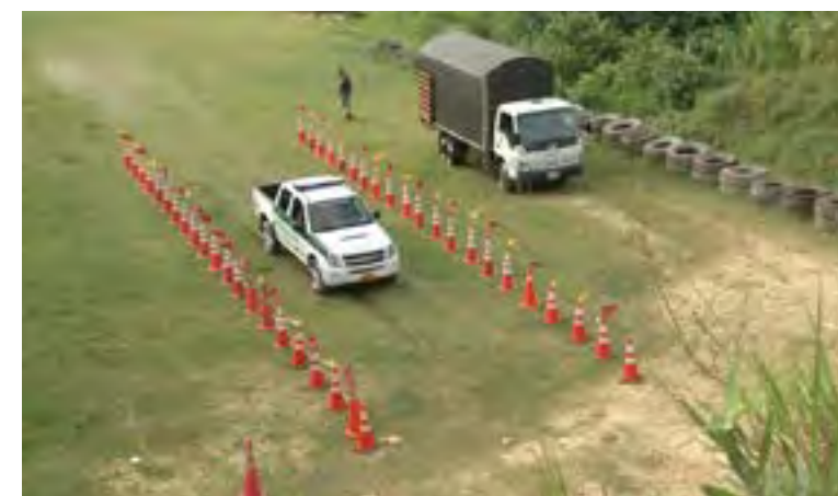
Imagen 117. Vehículo camioneta, pruebas de frenado de emergencia sobre césped en Ibagué Tolima. Fuente: Archivo Investigación Institucional ESEVI 2015.
