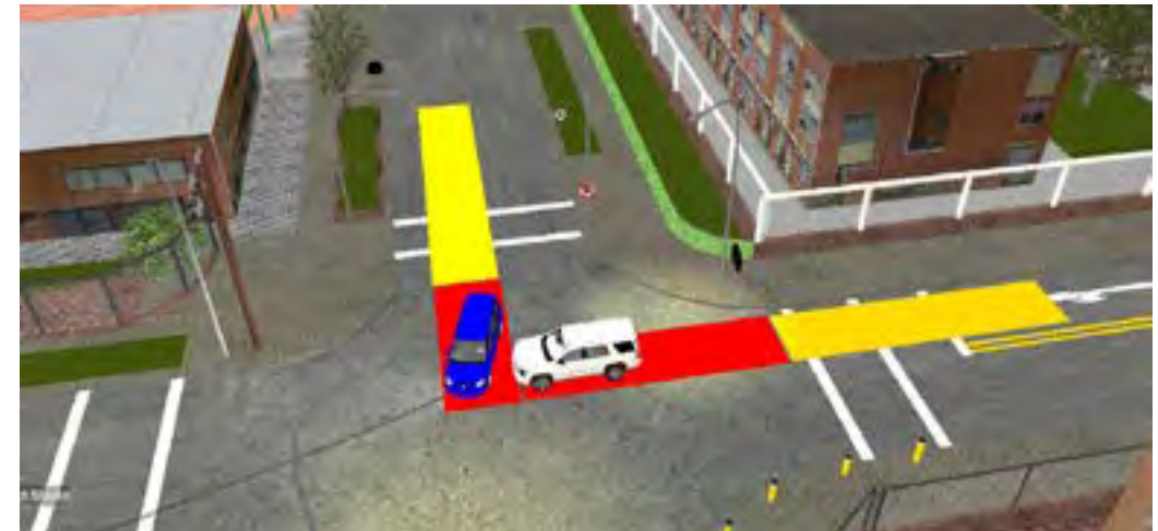
Imagen 19. Ejemplo de la escena de reacciones múltiples: Es la acción que toman los conductores frente al peligro inminente, que en este caso uno inició una frenada de emergencia y el otro inició una maniobra evasiva de giro a la derecha. Fuente: Archivo ESEVI docente Andrés Pinzón software EDGE FX
